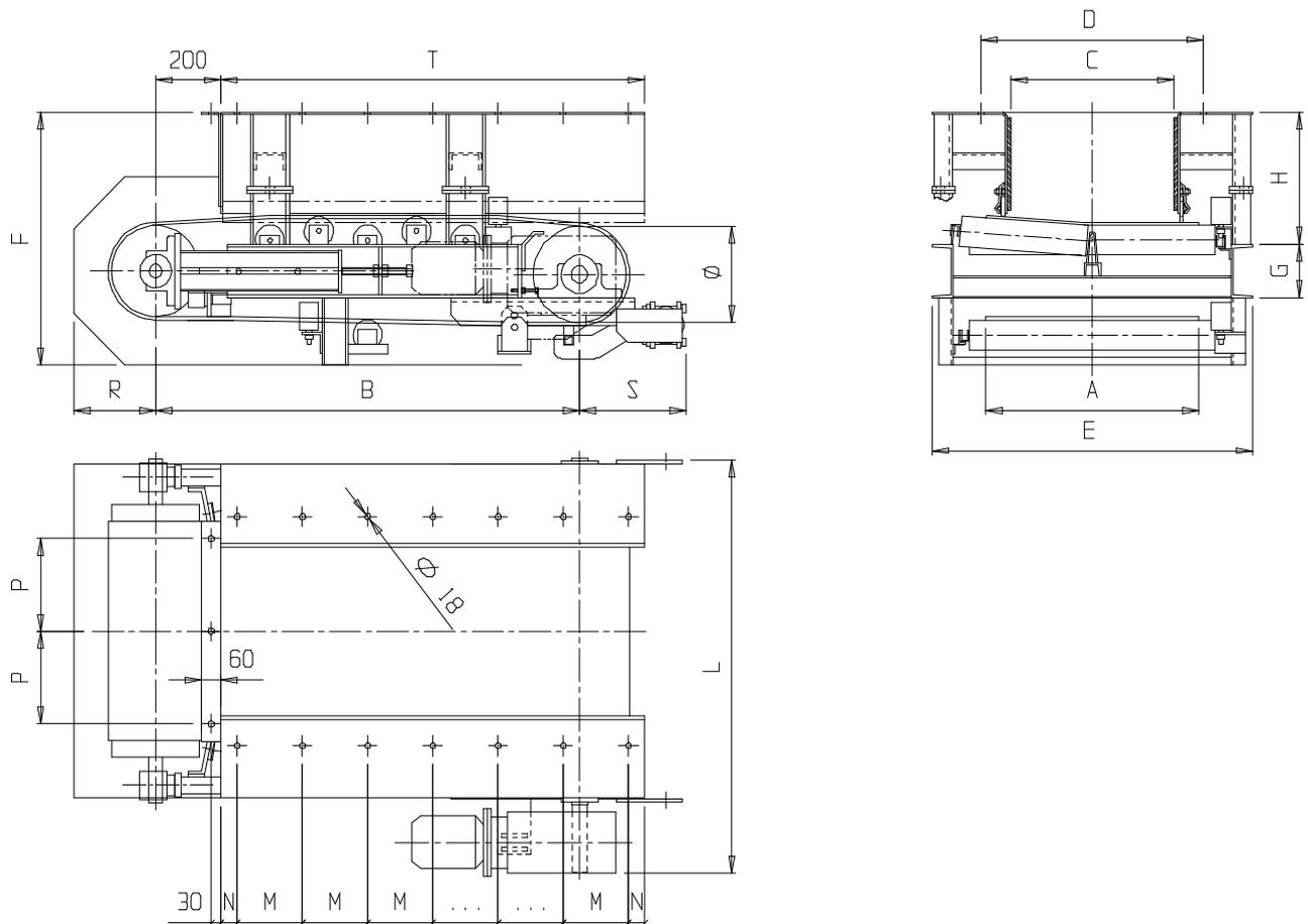
Per gli alimentatori a nastro della serie "AN", il trasporto del materiale avviene su un robusto tappeto azionato lentamente, la cui portata è regolabile. E' possibile l'applicazione di un sensore di strato per segnalare la presenza o l'assenza di materiale sul tappeto.
