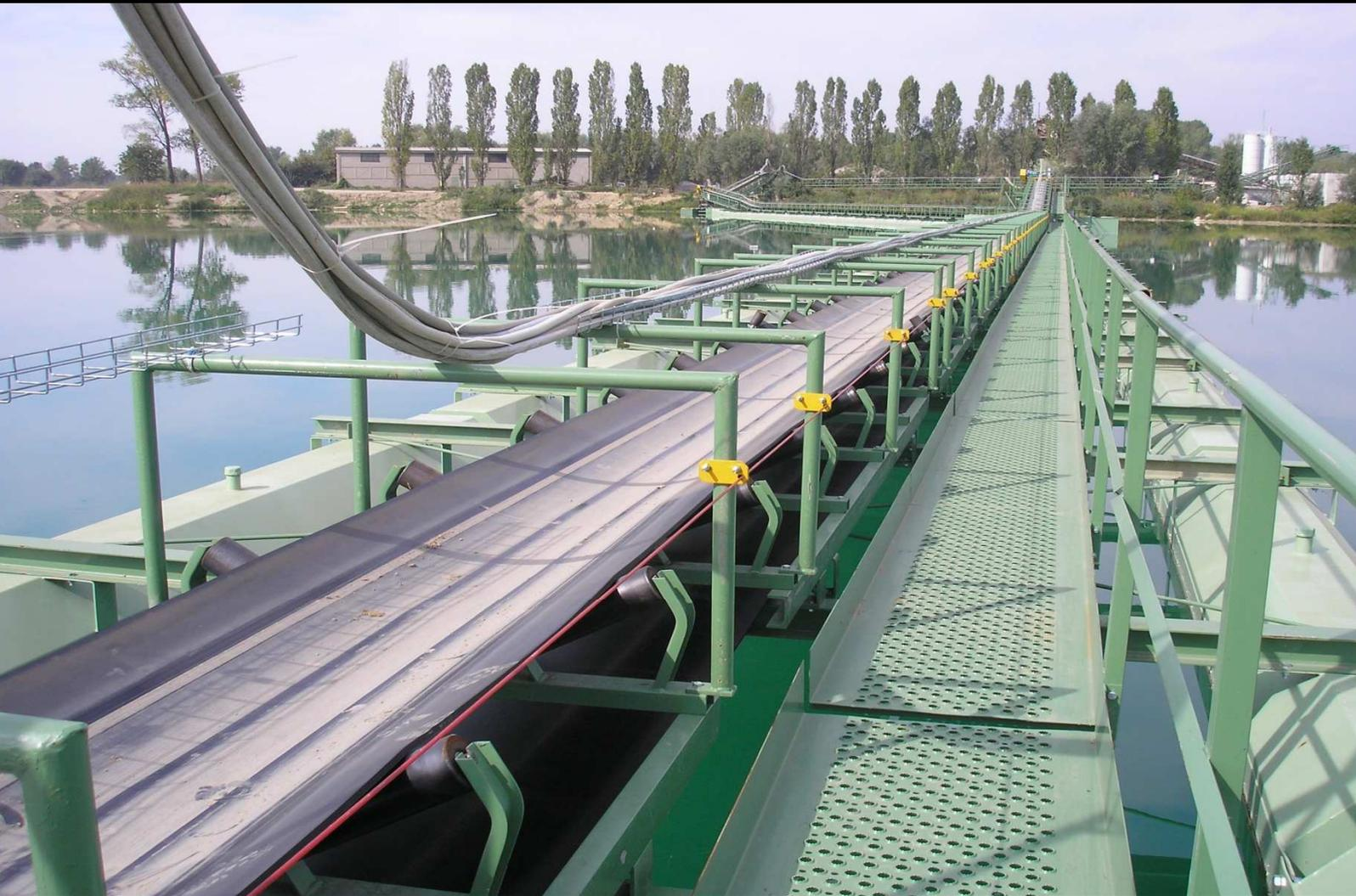
PER IL TRASPORTO DI MATERIALE DA UNA DRAGA DI ESCAVAZIONE SUBACQUEA FINO ALLA RIVA DI UN BACINO IDRICO
