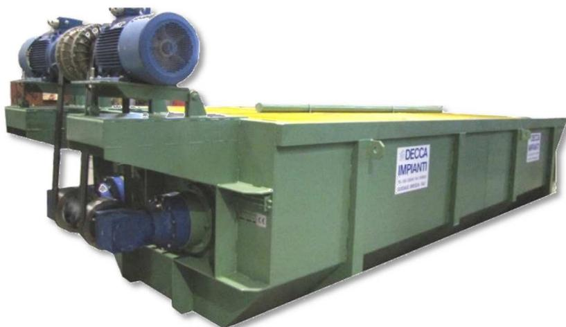
**disposizione elicoidale delle pale per un'intensa sfangatura ed un flusso uniforme del materiale allo scarico**
